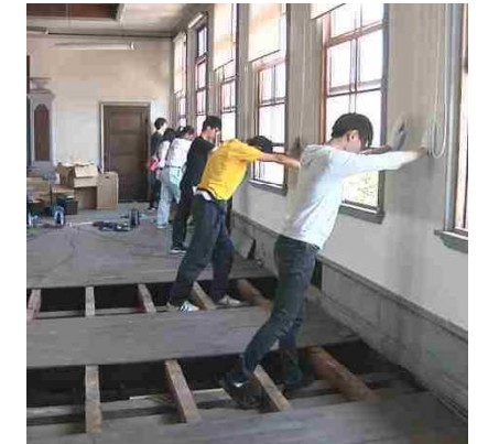
加振実験。機械だけでなく人力でも、リズムに合わせて建物に力を加えました
