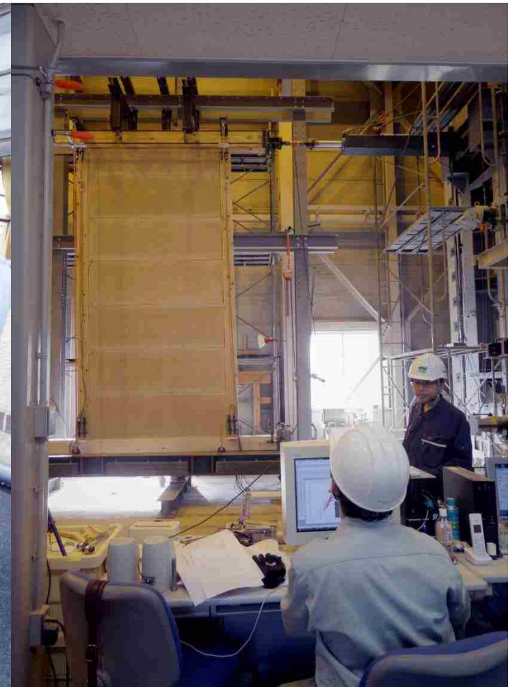
公立鳥取環境大学で再現土壁を用いた振動実験
