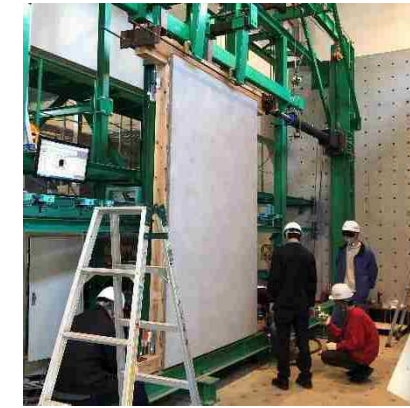
金沢工業大学での実物大実験。モルタルの外壁を再現し、地震力相当の力を加えました
