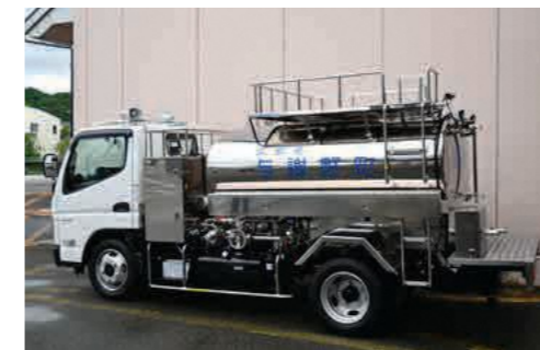
導入した加圧給水車（積載水量 2,800 リットル）
