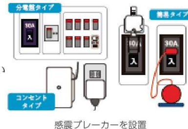
感震ブレーカーを設置
