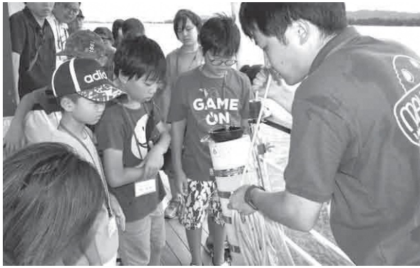
特殊な器具を使い、阿蘇海海底の水質を調査。海底の水だけを採取できる器具の仕組みに子どもたちは興味津々。
