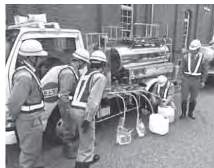
4市町で共同使用する加圧式給水車
