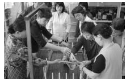
↑準備工程で最も重要な「整経」作業
